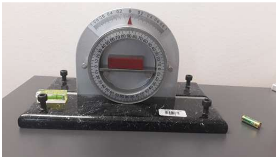
Слика 3 - Уређај за одређивање коефицијента трења клизања
